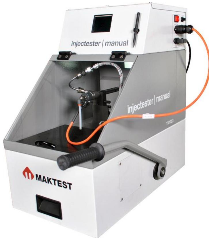
Injektoren werden gespült und der Inhalt in einem Glasbehälter gesammelt und auf Verunreinigungen untersucht. Sichtprüfung auf gutes Spritzbild und Kraftstoffzerstäubung. Düse Öffnungsdruck wird geprüft und ein statischer Lecktest durchgeführt, um auf Düsenleck zu prüfen.
